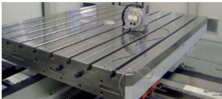
*In una macchina utensile gli errori geometrici degli assi determinano l'errore di posizionamento dell'utensile. Questo è un aspetto critico per la qualità dei pezzi lavorati.*
