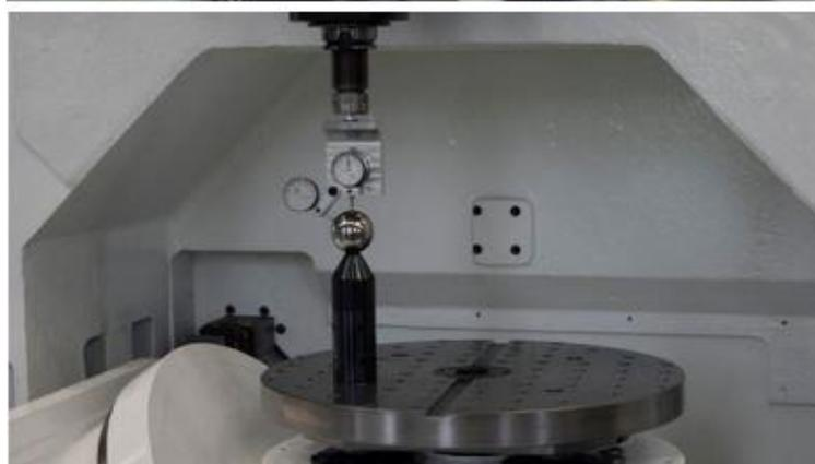
*Calibrazione geometrica di macchine utensili (messa in geometria) eseguita dai tecnici Atlem & Valtec è garanzia di qualità e precisione.*
